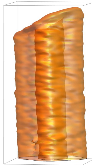
4DX線CT仮再構成 (シリコンチューブ)
